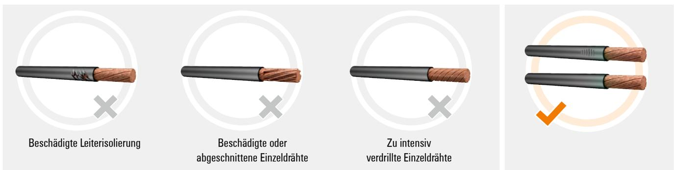
Abbildung 13: Beispiele einiger Abisolierfehler
