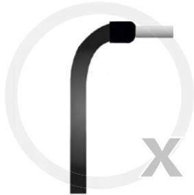
Abbildung 9: Bruchgefahr durch Überlastung - zu kleiner Biegeradius
