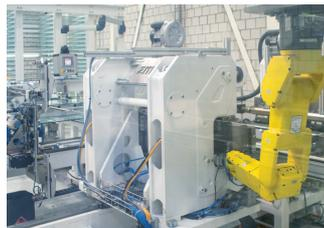
Das Prunkstück: Eine eigens für SIO entwickelte Anlage für die vollautomatische Verleimung von Glas und Profilen
