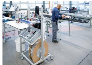
Lean-Spuren: Alle Montage-Arbeitsplätze sind auf Rollen, für den flexiblen Einsatz im Workflow
