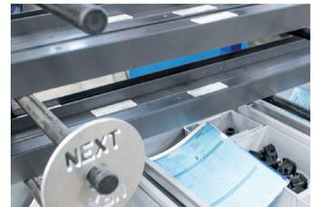
Lean-Spuren: EAN-Codes auf den Werkstücken, zugeordnete Teile und Marker für die Auftragsstrennung
