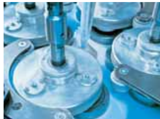
Mechanisches Schleifen und Polieren auf teils selbstgefertigten Maschinen ...
